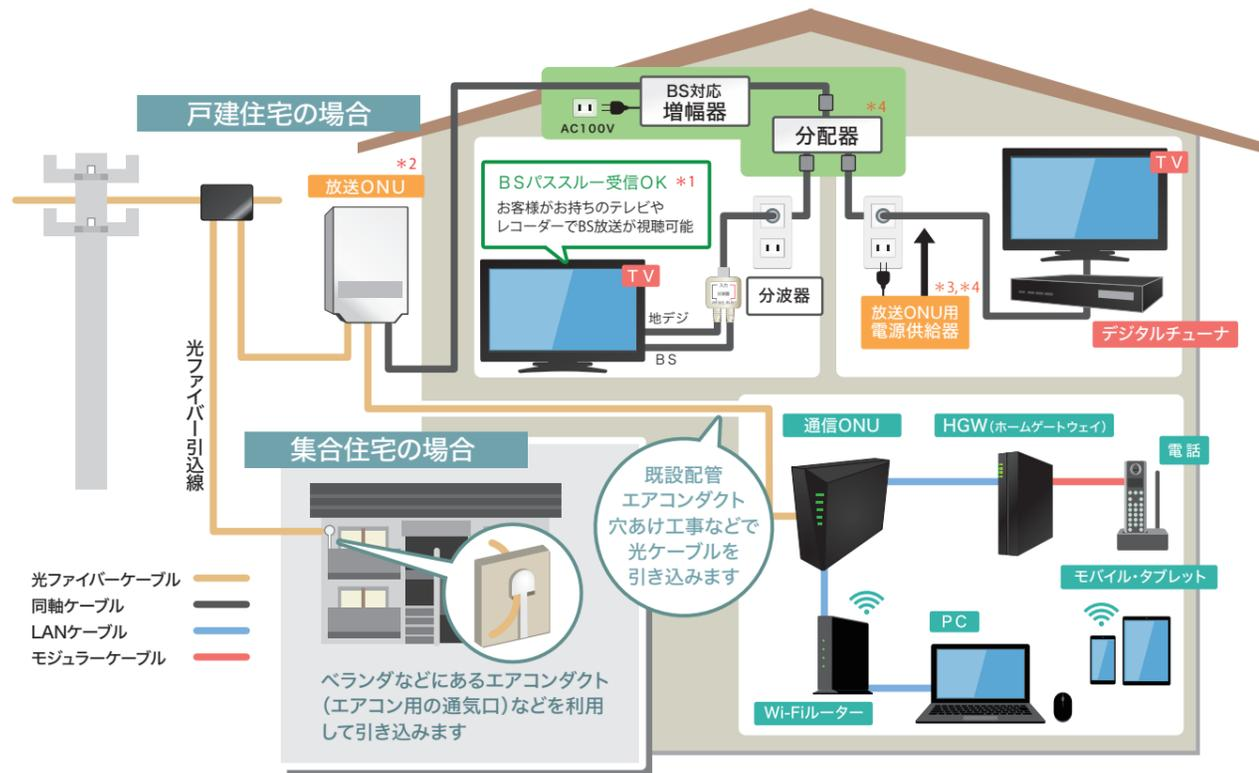
※図はイメージです。実際の工事とは異なる場合があります \*1 地デジコースはBSパススルー工事対象外です \*2 放送ONUは電源供給が必要です \*3 放送ONU用電源供給器は室内に設置します \*4 分配器交換や電源供給工事の関係で、天井裏や点検口に入る場合があります
